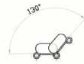
ANGOLO MASSIMO AMMESSO A TAPPARELLE ASSEMBLATE
