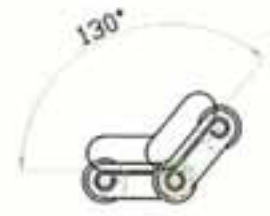
ANGOLO MASSIMO AMMESSO A TAPPARELLE ASSEMBLATE
